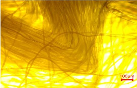
Image au microscope optique des fibres PLA
